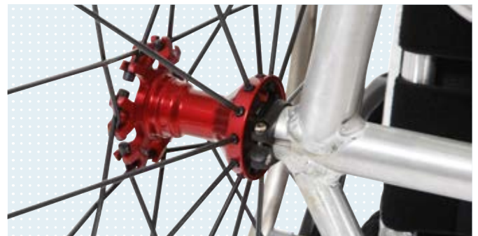
Die Sport-Steckachse im Maß 5/8" (15,8 mm) ist äußerst robust.
